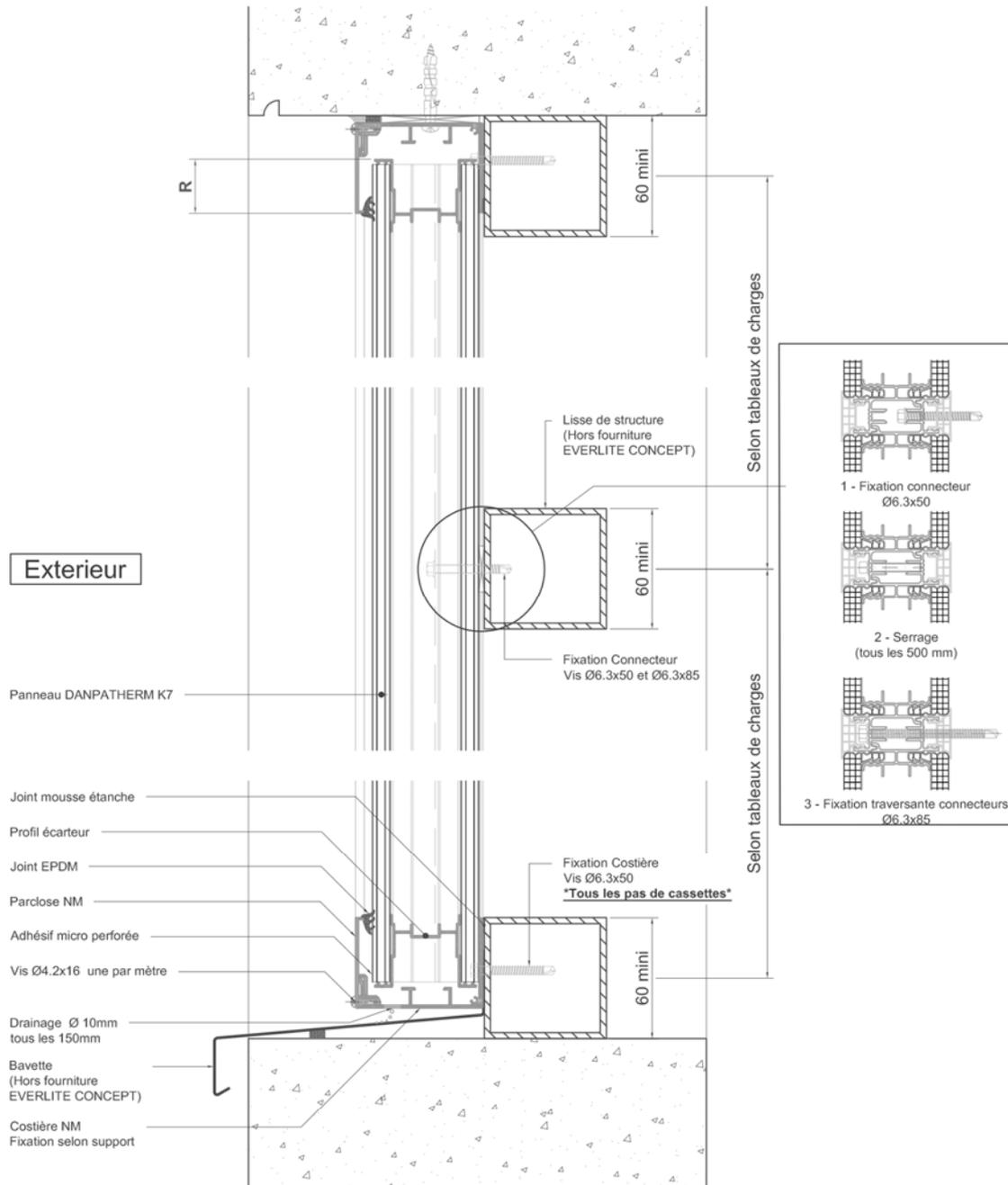
Figure 7 - Coupe verticale avec costière NM – Pose en tableau
