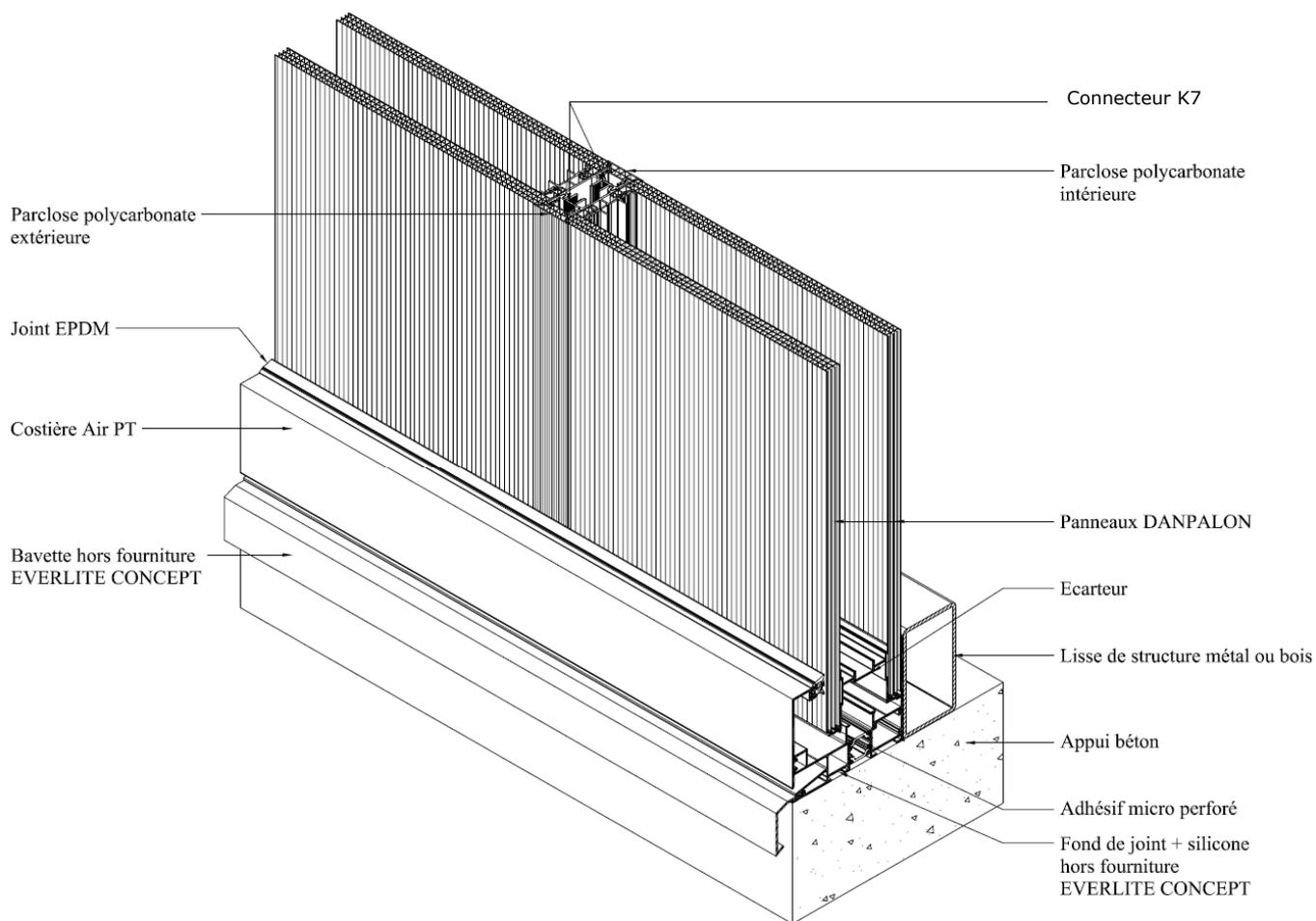
*Figure 4 – Principe de mise en œuvre K7*
