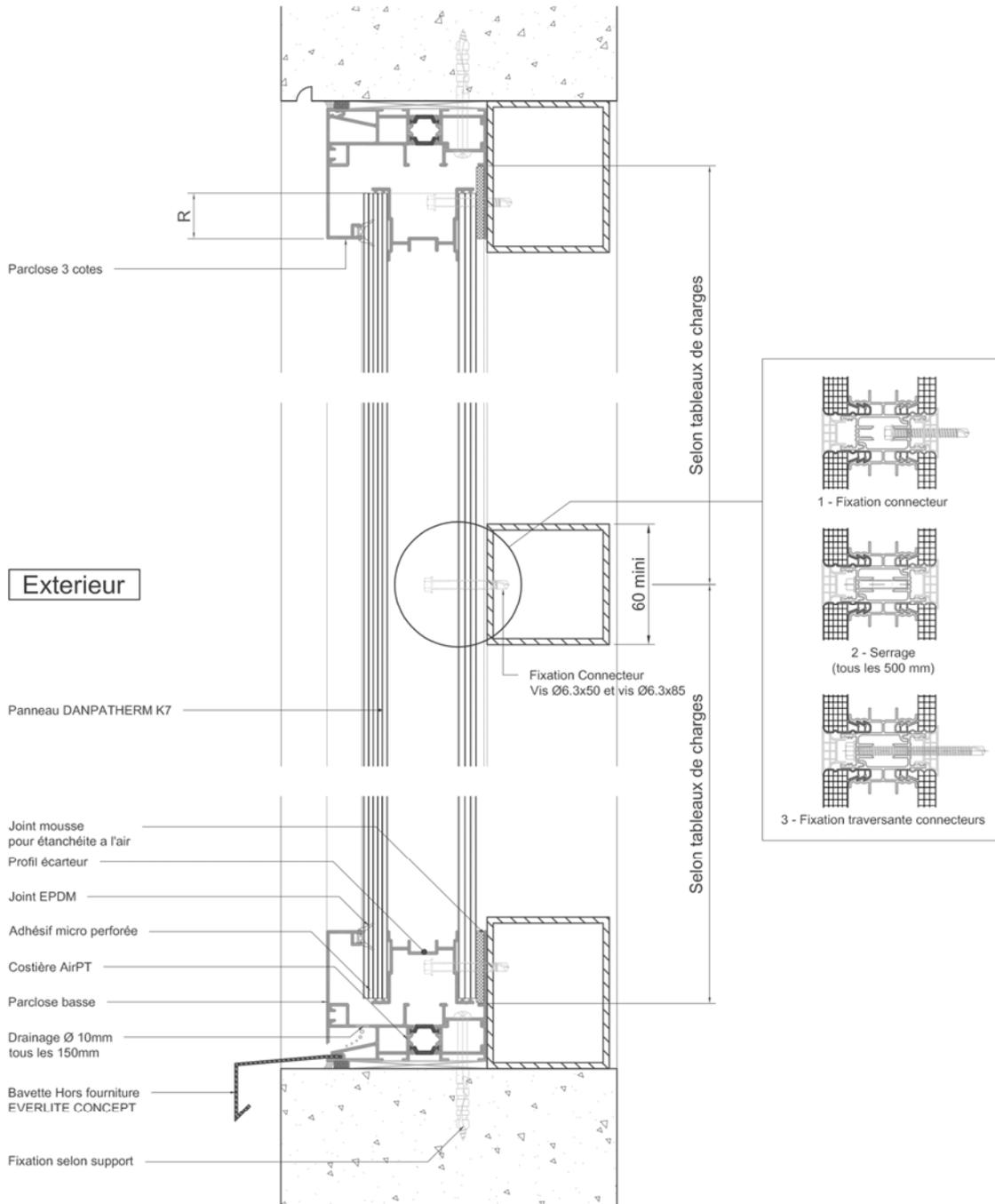
Figure 11 - Coupe verticale avec costière AirPT – Pose en tableau
