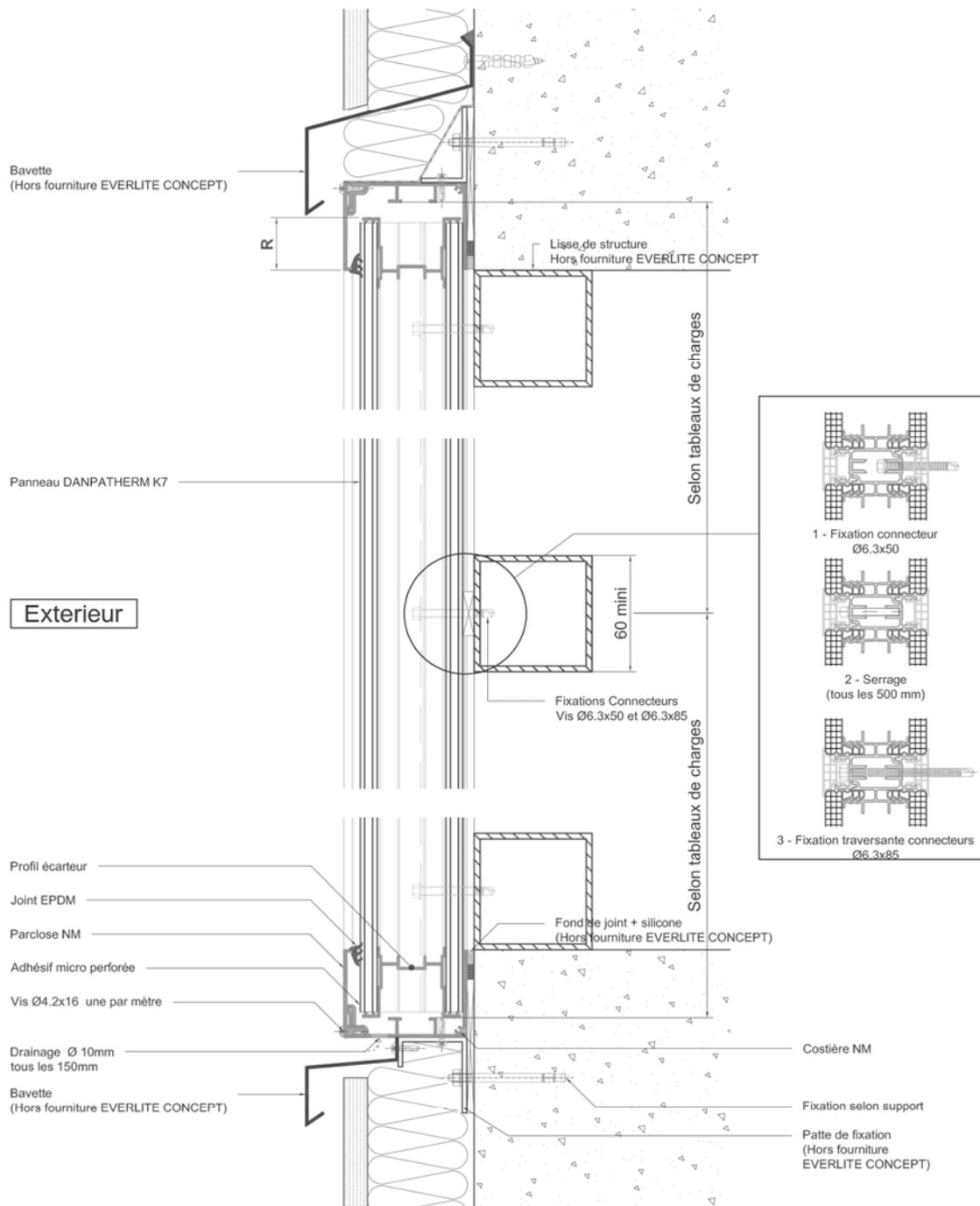
Figure 5 – Coupe verticale avec costière NM – Pose en applique
