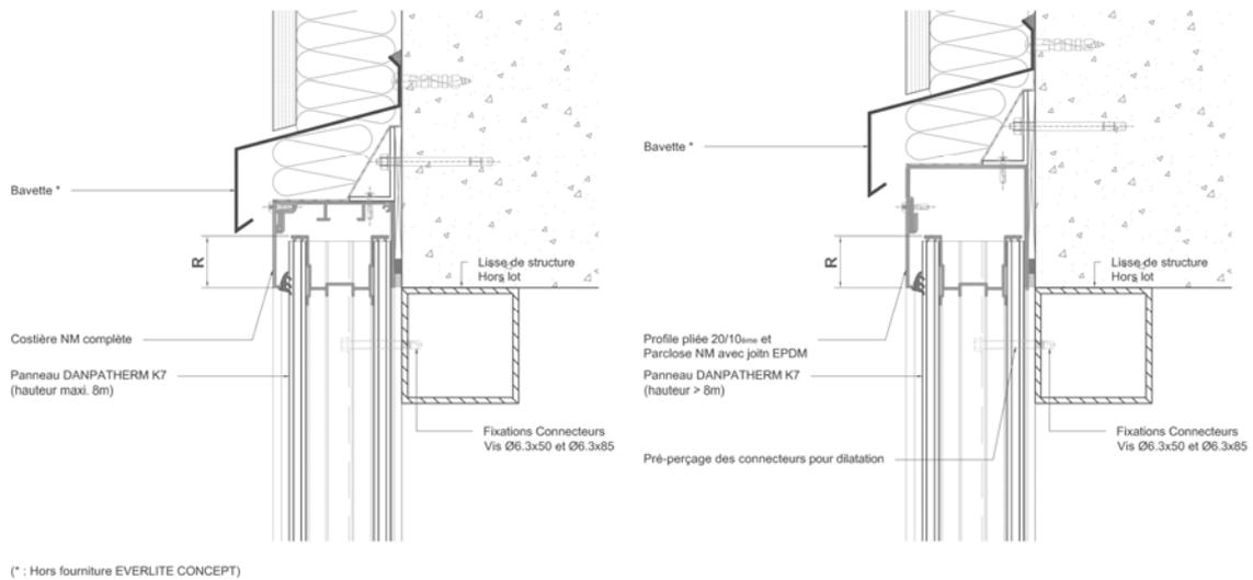
**Figure 15 – Recouvrement au point haut**
