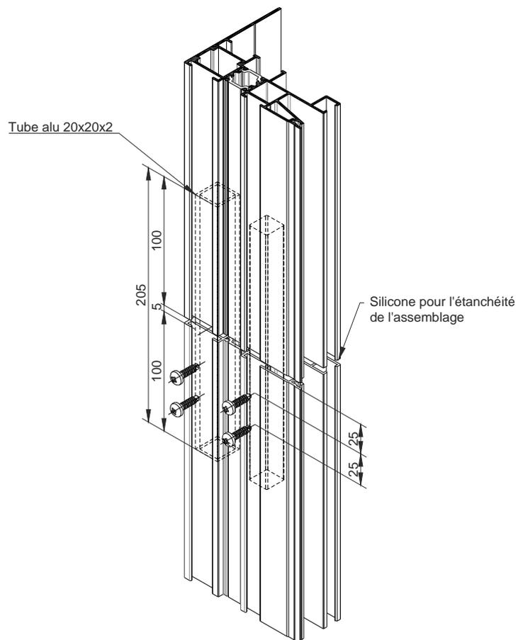
Figure 3.3 – Profils aluminium périphériques – Exemple d'éclissage
